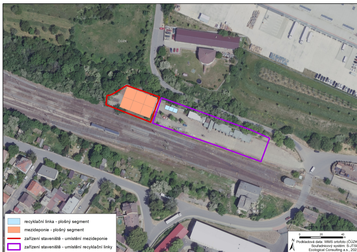
Obr. 5. Schematický zakres rozdělení a umístění plošných zdrojů znečištění v místě zařízení staveniště v blízkosti žst. Hostivice (umístění je orientační, v době realizace se může změnit v rámci celé plochy zařízení staveniště)
