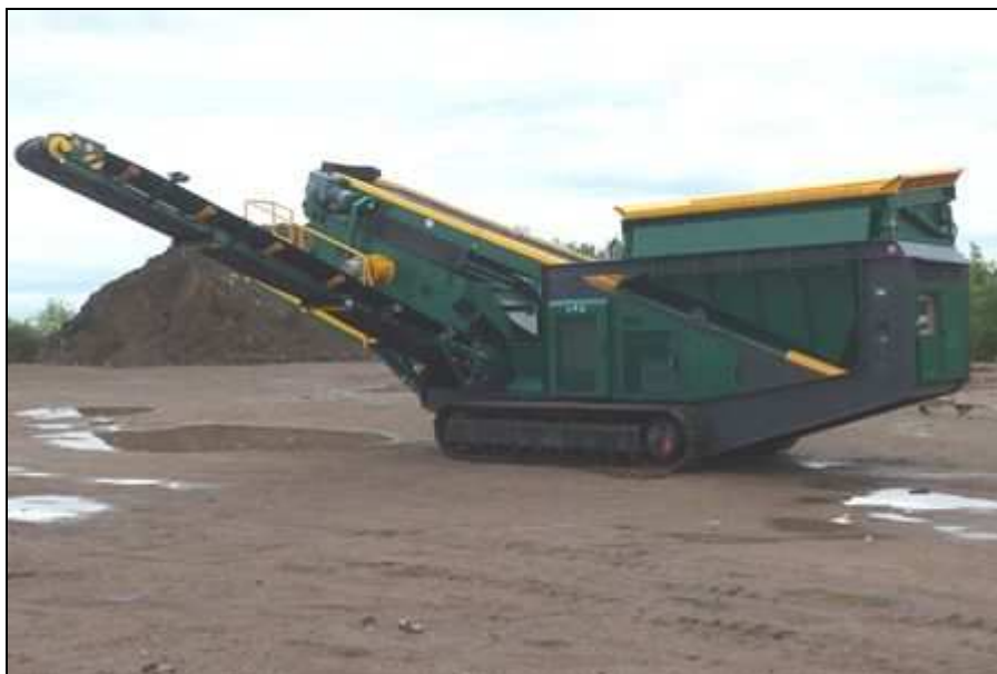
Obr. 4. Příklad použité recyklační linky: Jednotka Resta TH1 (zdroj: www.resta.cz )
