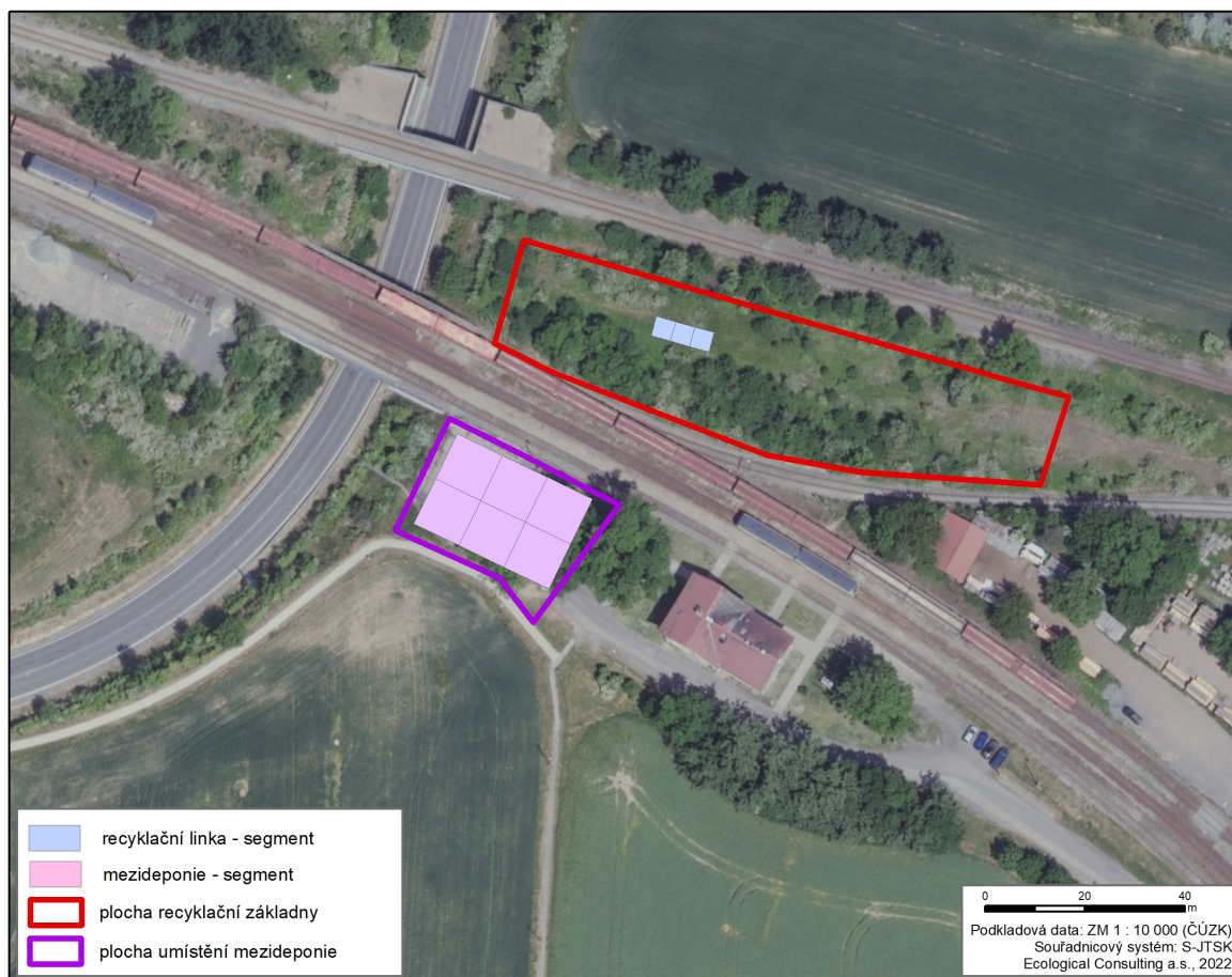
Obr. 5. Schematický zakres rozdělení a umístění plošných zdrojů znečištění v místě zařízení staveniště v blízkosti žst. Jeneč (umístění je orientační, v době realizace se může změnit v rámci celé plochy zařízení staveniště)
