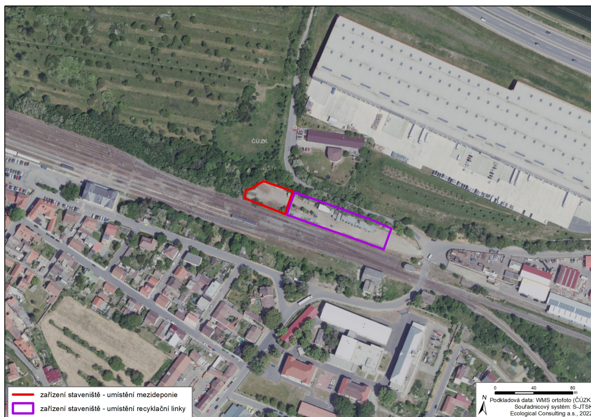
Obr. 3. Umístění zařízení staveniště pro recyklační základnu a mezideponii zrecyklovaného materiálu – bližší pohled
